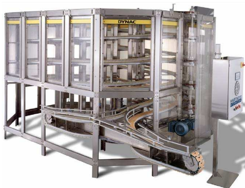
图1 Hartness International 的DYNAC 传送系统在包装和打包过程中智能地控制各种产品流
