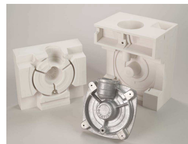
图8ZCast 三维打印成型模型和铝铸件
