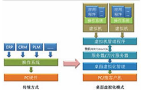
图6 从传统架构到桌面虚拟化架构
