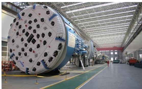
图 3 与外商合作制造的 \phi 8\text{m} 全断面隧道掘进机
